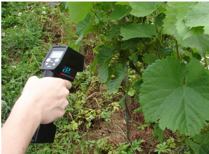
Priloga 3: Laserski termometer za merjenje temperature grozdnih jagod.
